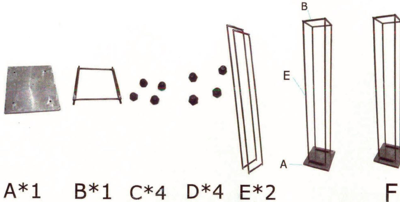
1. Schritt: Stecken Sie beide Teile E mit der Spitze nach unten in die Bohrungen von Teil A und schrauben Sie diese mit Teil D an der Unterseite fest.
